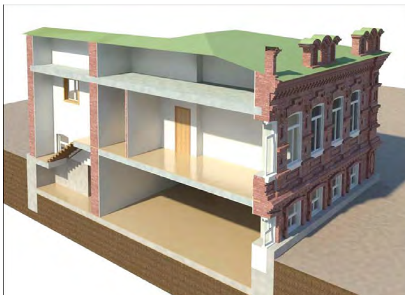
Рис. 2-1-22. Татьяна Козлова. Памятник архитектуры «Дом композиторов» в Новосибирске: трехмерный разрез здания. Модель выполнена в Revit Architecture. НГАСУ(Сибстрин), 2009
