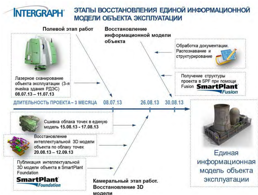
Рис. 9. Этапы восстановления единой информационной интеллектуальной трехмерной модели объекта эксплуатации
