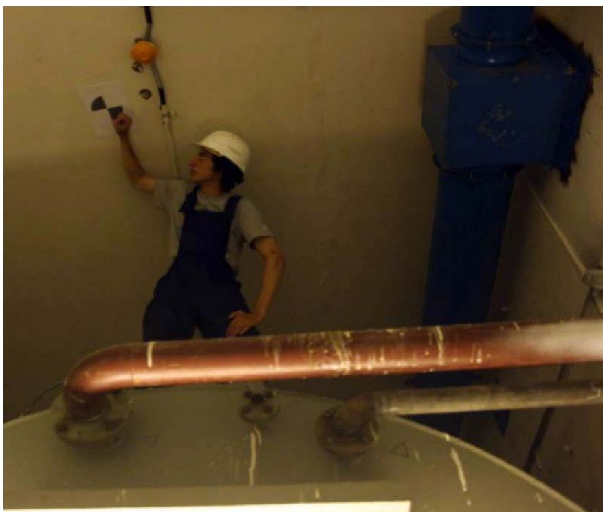
Рис. 6. Размещение специальных марок, используемых для регистрации сканов
