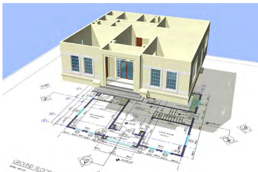
Рис. 1. Фрагмент модели – план этажа как проекция.
