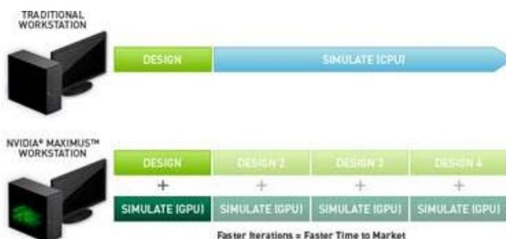
Maximus — это новый драйвер для графики Quadro и графических плат Tesla, который распределяет задачи так: те, что выполняются на OpenGL (или Direct3D), направляются на плату Quadro, а работающие с CUDA (или OpenCL) — на плату Tesla. При этом ЦП вовсе не игнорируется, одна половина его ядра поддерживает визуализацию на ГП Quadro, а другая — моделирование и рендеринг на Tesla.
