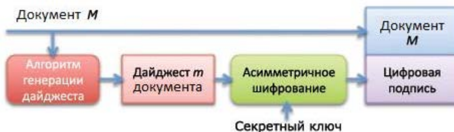
Рис. 3. Схема создания ЭЦП на документе
