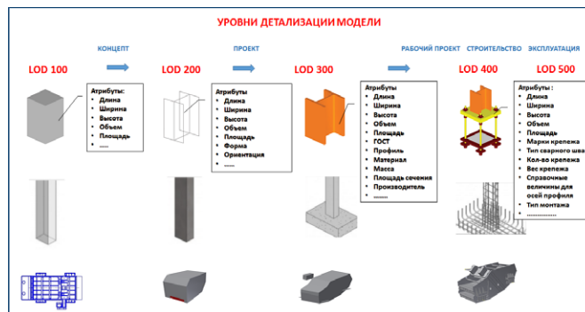
Рис. 1 Прогрессирование уровней детализации по мере разработки строительного проекта
