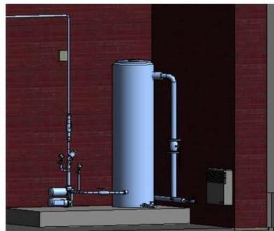
Фрагмент обвязки бака для жидкости и насосной станции
