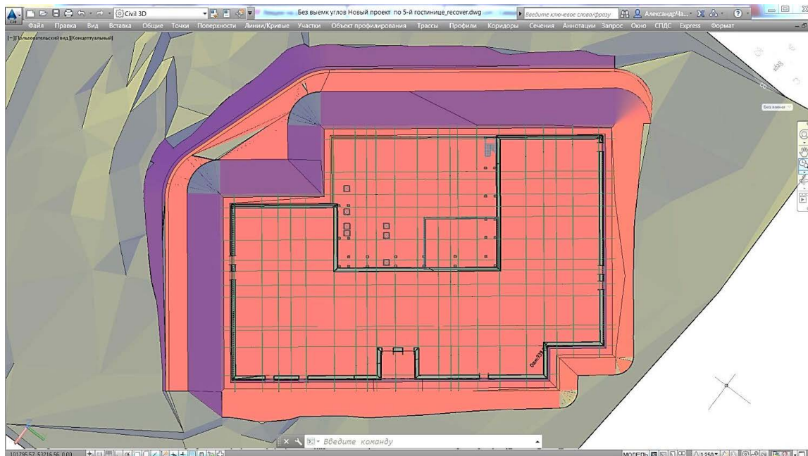
Рис. 17. План котлована совмещенный с чертежом фундамента
