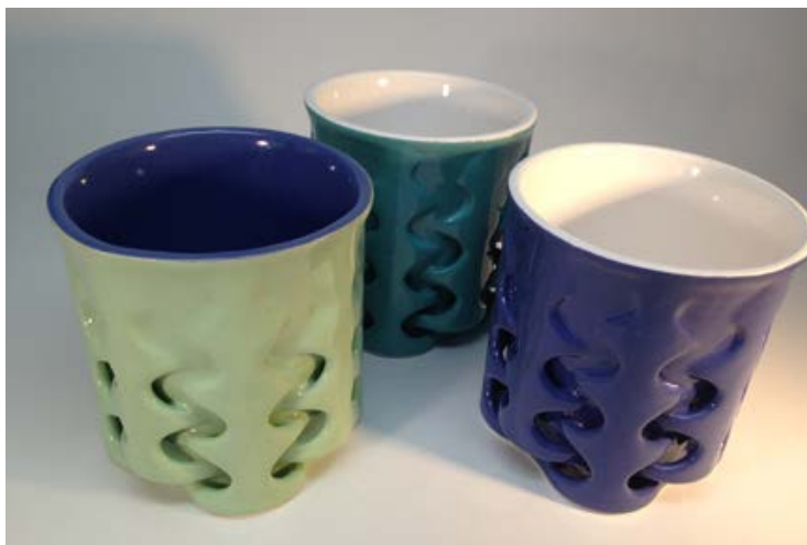
Цветные керамические чашки, напечатанные с помощью 3D-принтера CeraJet
