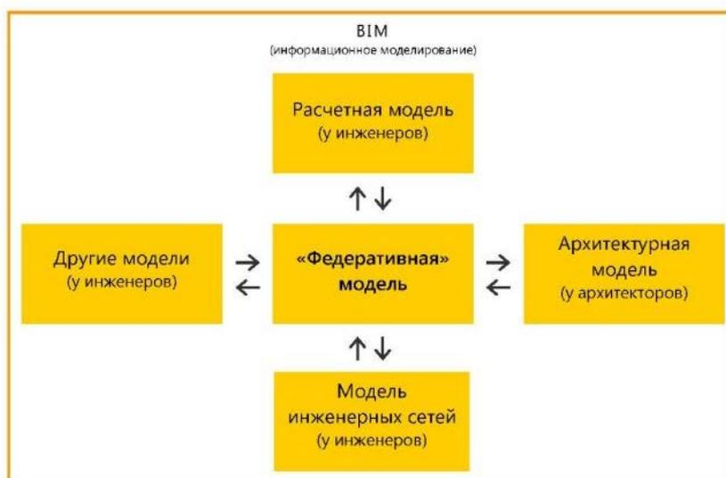
Рис. 2. Идеальная схема взаимодействия моделей в ряде вариантов парадигмы BIM
