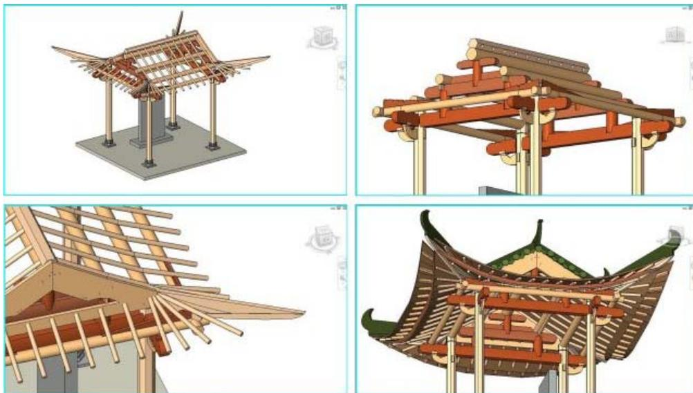
Рис.3. Моделирование системы доу-гун и других элементов конструкции.
