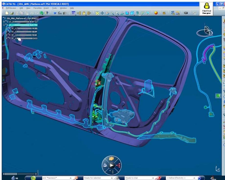
Увеличиваем нужную деталь: здесь также видны другие элементы электрики, встроенной в двери: механизм поднятия стекла, кнопки в водительской двери, концевые выключатели и т.д.
