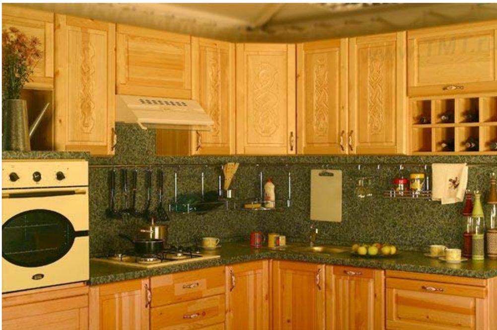
Ранее такие фасады изготавливались исключительно вручную, резчиками по дереву, но применение специализированных САПР, обеспечивающих моделирование таких рельефов в 3D, позволяет автоматизировать производство с применением станков ЧПУ, что и происходит на практике.
