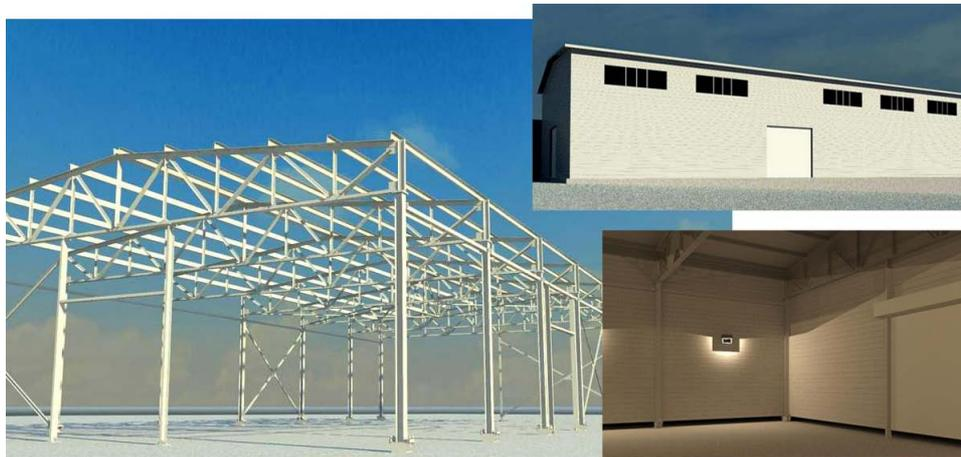
Рис 13. Визуализация модели, выполненная в Revit Structure.
