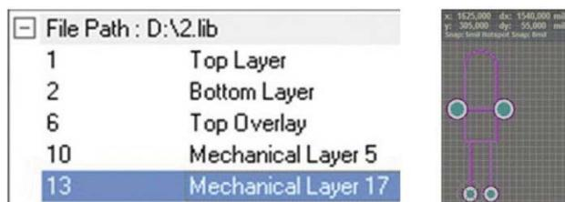
Рис. 4. Конвертация резонатора в Altium Designer с применением слоя Mechanical 17
