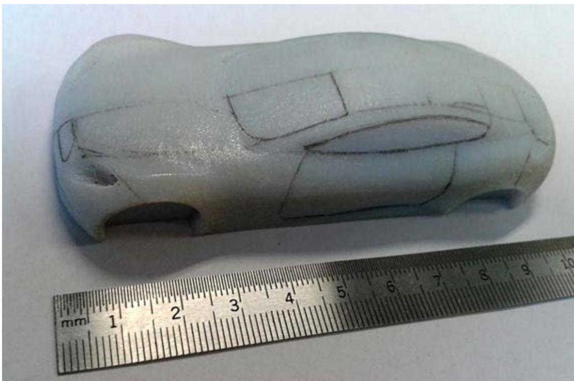
*3D-модель длиной 10 см, напечатанная на принтере Objet260 Connex, позволяет убедиться в сбалансированности пропорций концепт-кара*
