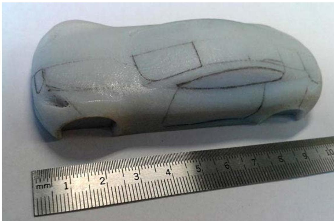
*3D-модель длиной 10 см, напечатанная на принтере Objet260 Соппех, позволяет убедиться в сбалансированности пропорций концепт-кара*
