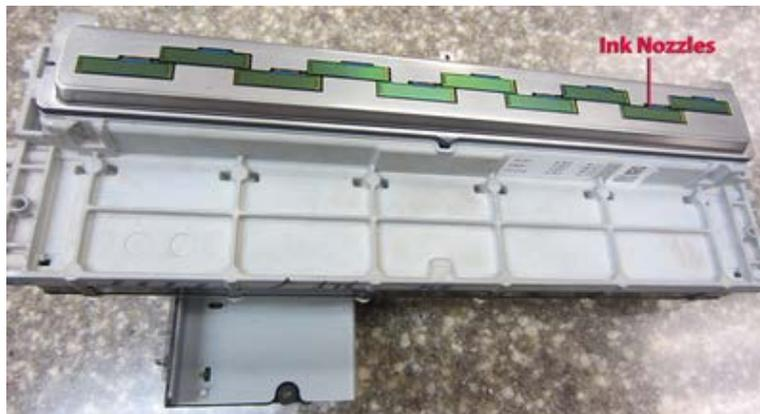
Блок печатающей головки, из которых состоит печатающая полоса, имеет 200 тысяч сопел, выпускающих 6-пиколитровые капли чернил. Сейчас скорость печати дошла до 3 метров в секунду при цветной печати и 4 метров в секунду при черно-белой.
