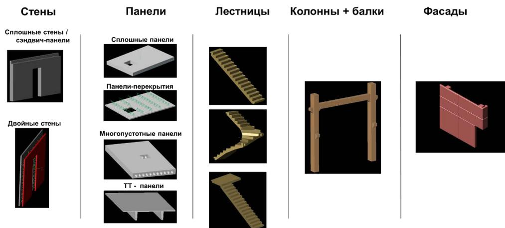
Рис. 4. Элементы конструкций, описываемые в базе данных IDAT
