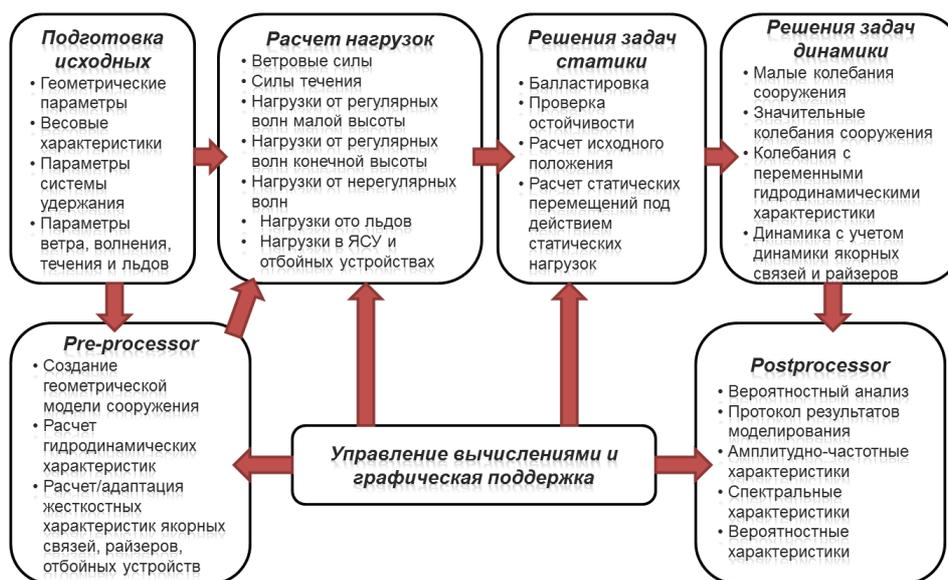
Рис. 1. Структурная схема ПК Anchored Structures
