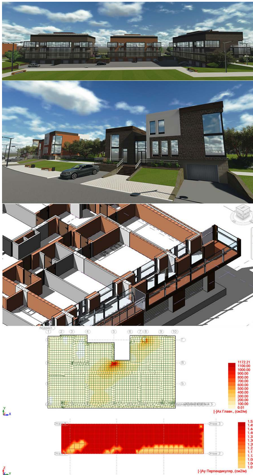
Рис. 7. Ирина Ложкина. Эскизный проект дома для малоэтажной застройки острова Русский во Владивостоке. Модель выполнена в Revit Architecture, проверка идеи дома на сейсмическую устойчивость - в Autodesk Robot Structural Analysis. НГАСУ(Сибстрин), 2013.
