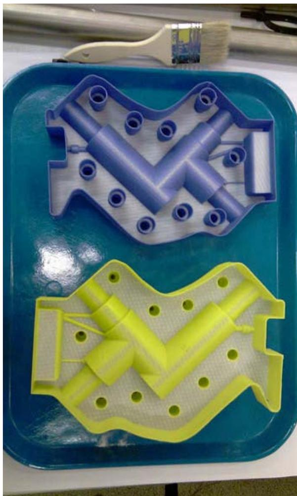
*Форма для литья, полученная по технологии с использованием трехмерного принтера*
