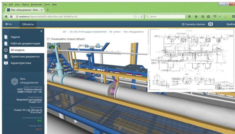
Рис. 3. Пример реализации доступа к данным (характеристики задвижки) посредством 3D модели и 2D чертежа
