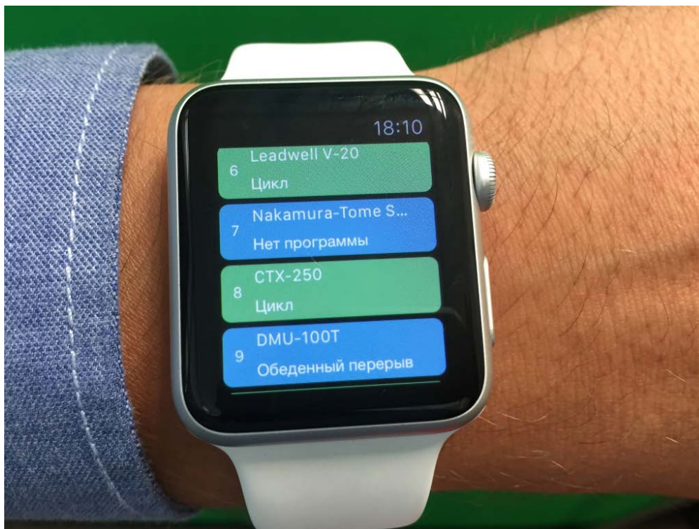
Рис. 1. Приложение "MonitoringCNC" позволяет контролировать работу станков с ЧПУ прямо на запястье, в любой точке мира при наличии iPhone и доступа в Интернет
