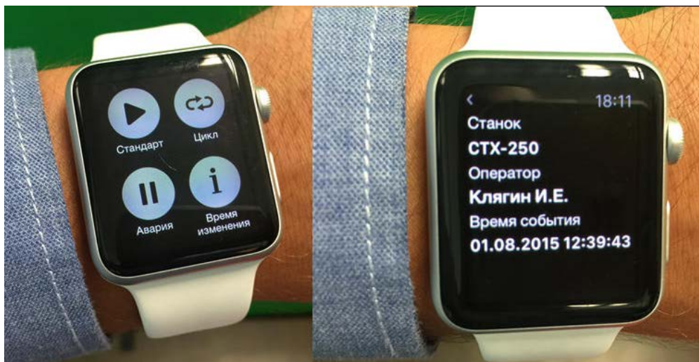
Рис. 2. Экраны Apple Watch с выбором способа сортировки событий (слева) и данными об операторе и текущем производственном задании (справа)
