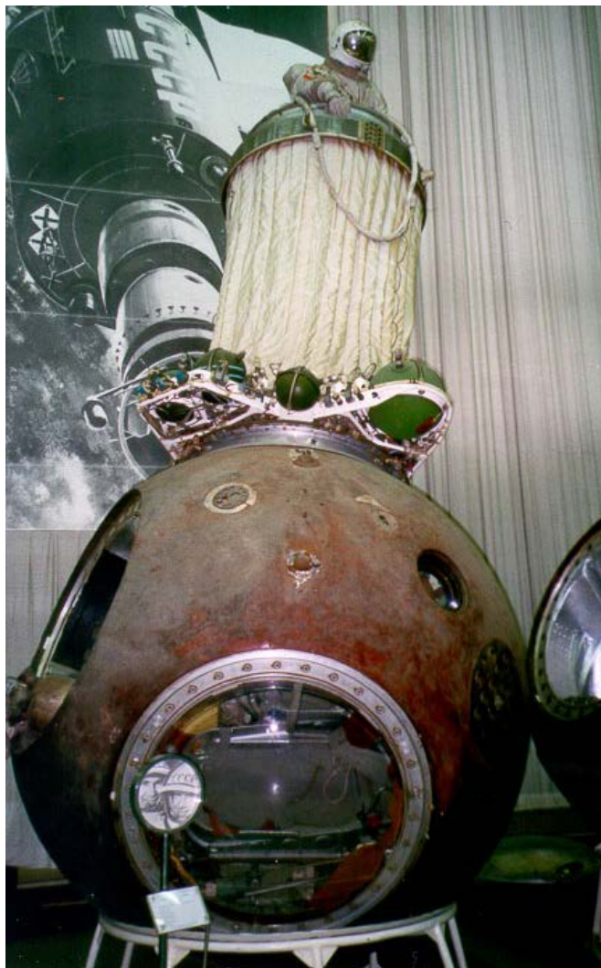
Шлюзовая камера корабля «Восход-2»
