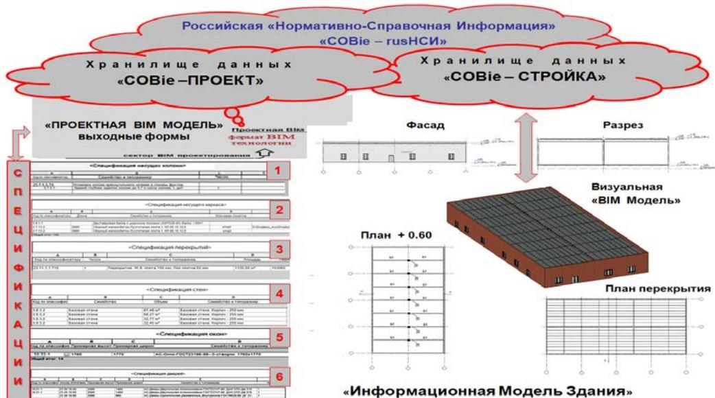
Рисунок 8. Проект встроенного помещения «Многофункционального Центра Трудовой Миграции» передача спецификаций из «Проектной BIM Модели» в «Строительную BIM Модель».
