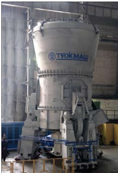
Мельница углеразмольная валковая среднеходная МВС 265
