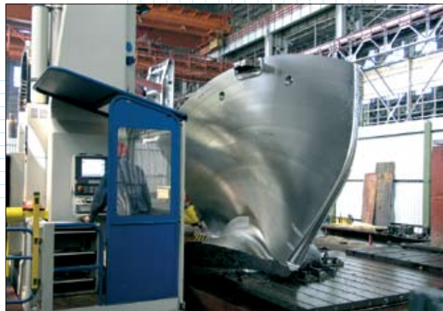
Обработка лопасти турбины для Нижегородской ГЭС (масса изделия 20 тонн)
