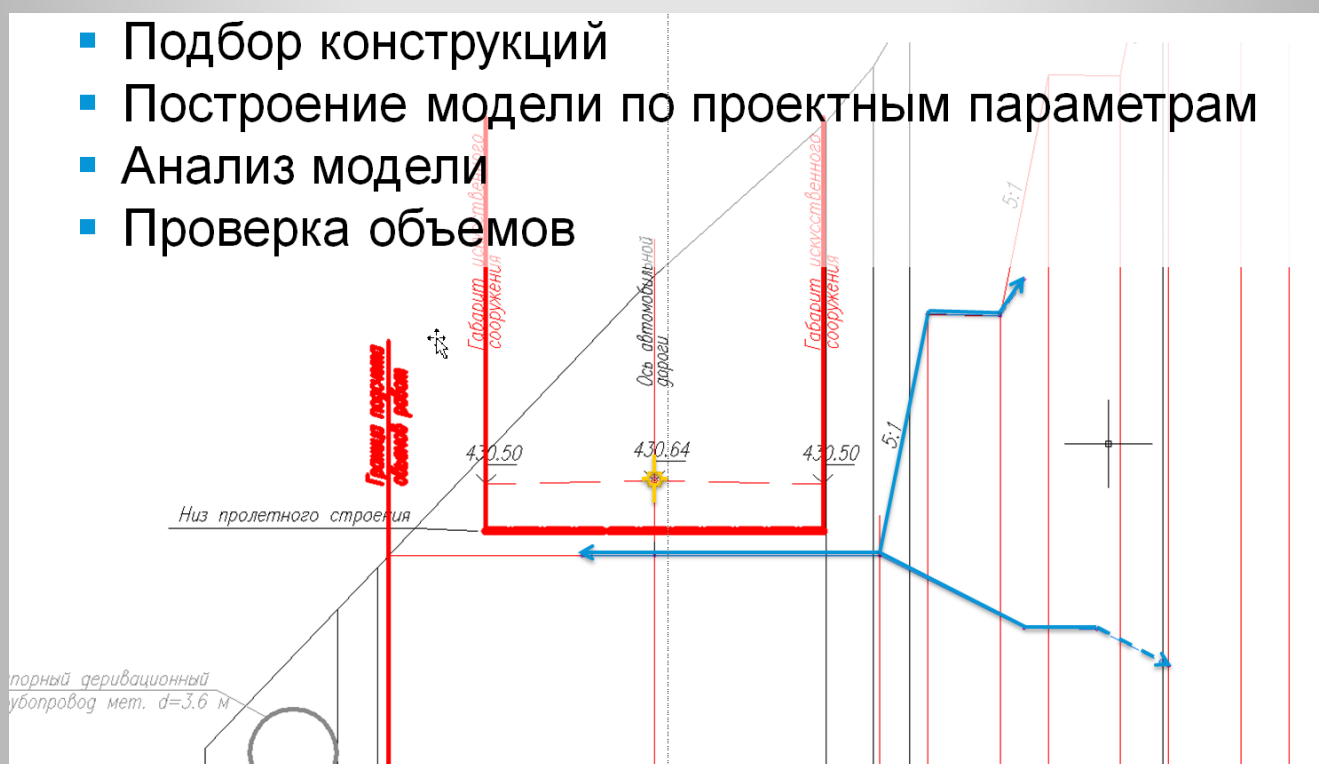
Рис. 3. Расстановка конструкций по поперечникам
