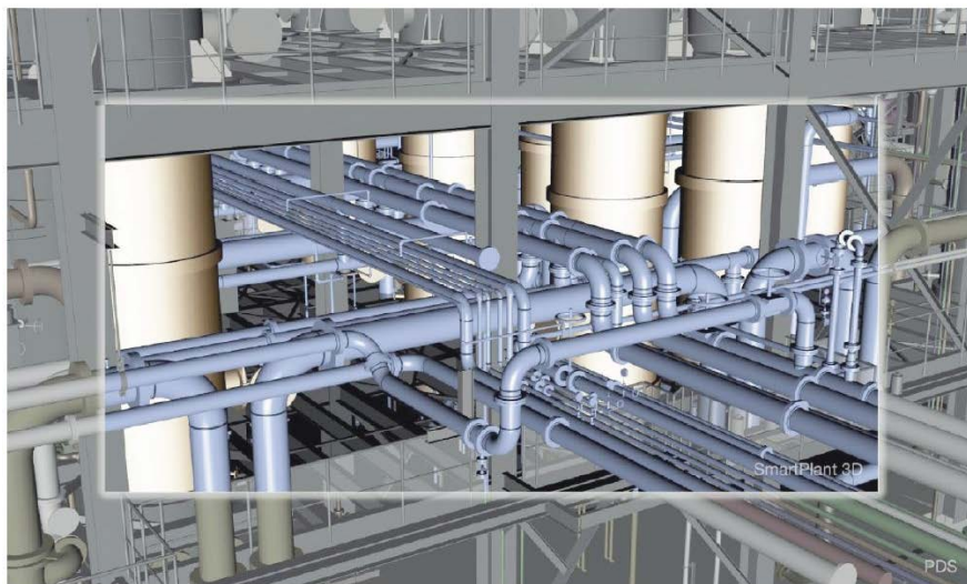
Рис. 4. Представление 3D-модели пользователю SmartPlant Review. Средняя часть спроектирована с применением САПР Intergraph SmartPlant 3D, остальное — с помощью САПР Intergraph PDS
