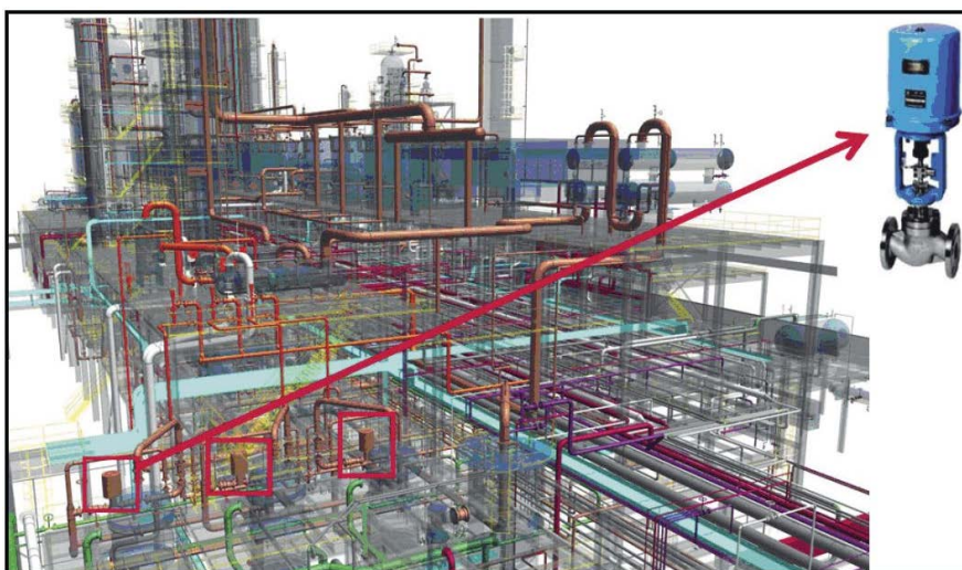
Рис. 2. Ссылка на оборудование. При инициализации производится переход к документации и 3D-модели
