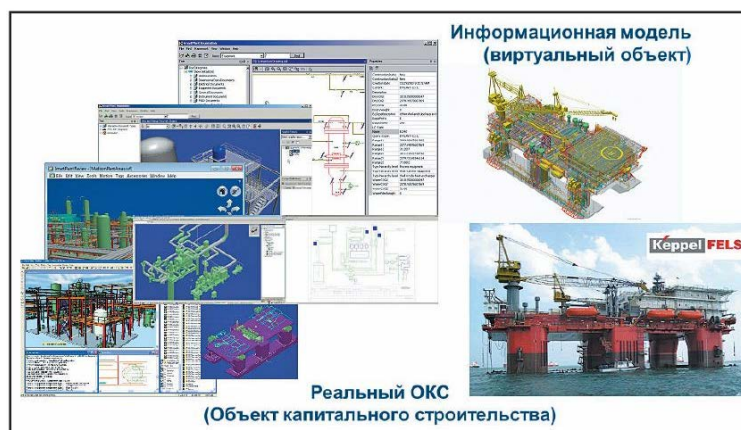
Рис. 1. Реальный ОКС адекватно отражается в информационной модели
