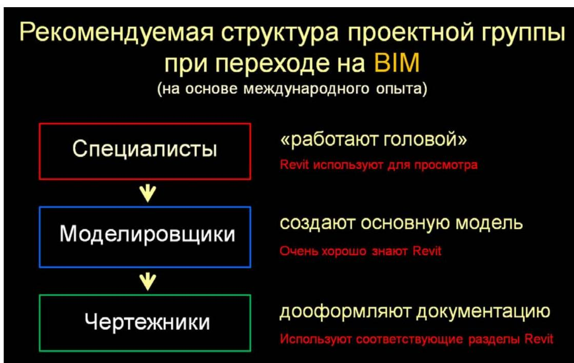
Рис 2. Рекомендуемая структура проектной группы при выполнении проекта на основе информационной модели здания.
