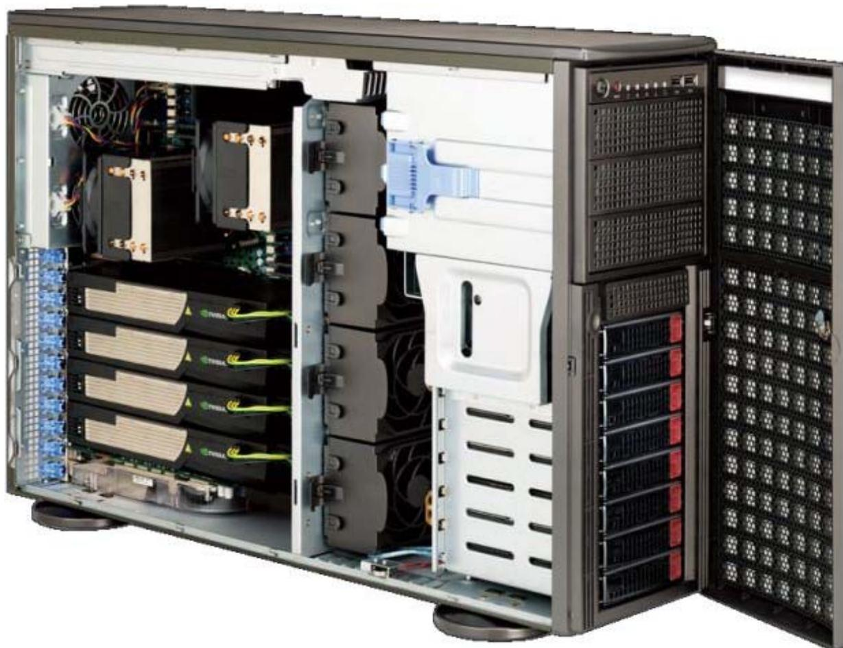
В Microway 4U GPU используются два четырех- или шестиядерных CPU Intel Xeon и до четырех модулей NVIDIA Tesla
