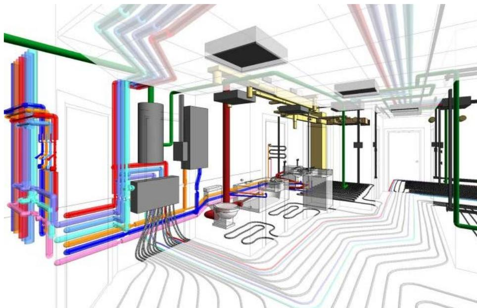
Рис. 2. Игорь Козлов. Инженерное оборудование энергоэффективного здания. Работа выполнена в Revit MEP.
