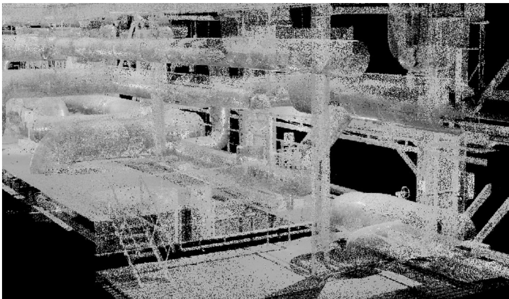
Рис.3. Фрагмент облака точек электростанции
